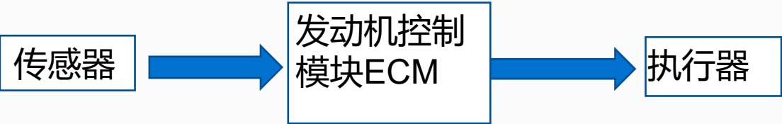
图1-29传感器、控制器和执行器之间的工作关系
